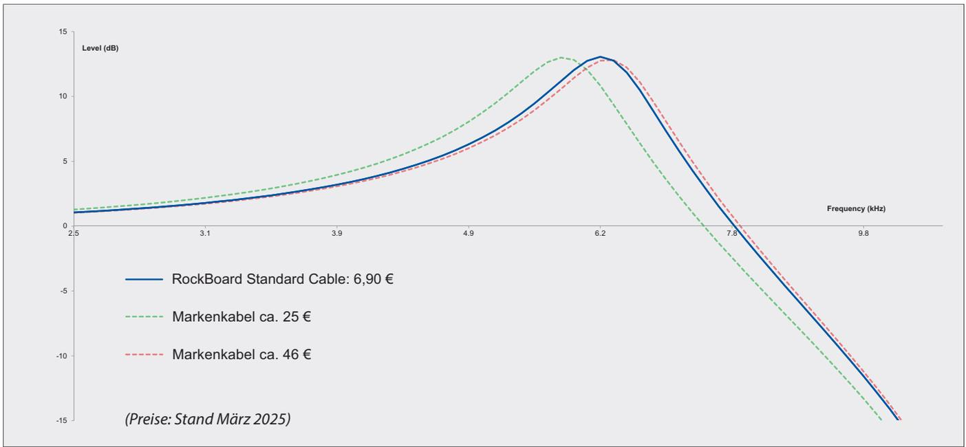
Frequenzganganalyse für 3 m Instrumentenkabel verschiedener Hersteller.
