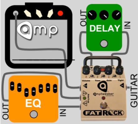
**Zwei Amps** – FR geht zum schwarzen Amp, Clean geht zum Tweed. An einem der Amps kann ein Ground Lift erforderlich sein.
