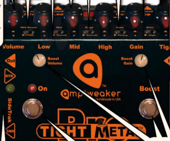
**SideTrak Loop** - cette boucle est active quand la TM PRO est by-passée. Send sur entrée « clean effects », Return sur sortie « clean effects ».
