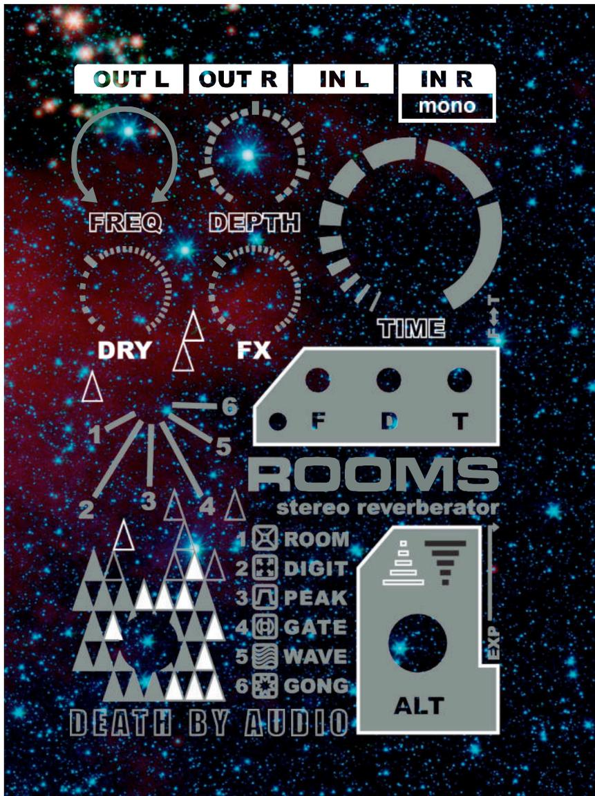
**CONNEXIONS :** Se brancher sur l'entrée **IN R** mono divise le signal dry vers les deux sorties. Sur, **IN L** les signaux de droite et gauche vont vers leurs sorties respectives. Le signal wet circule en cascade pour une image stéréo étendue.
