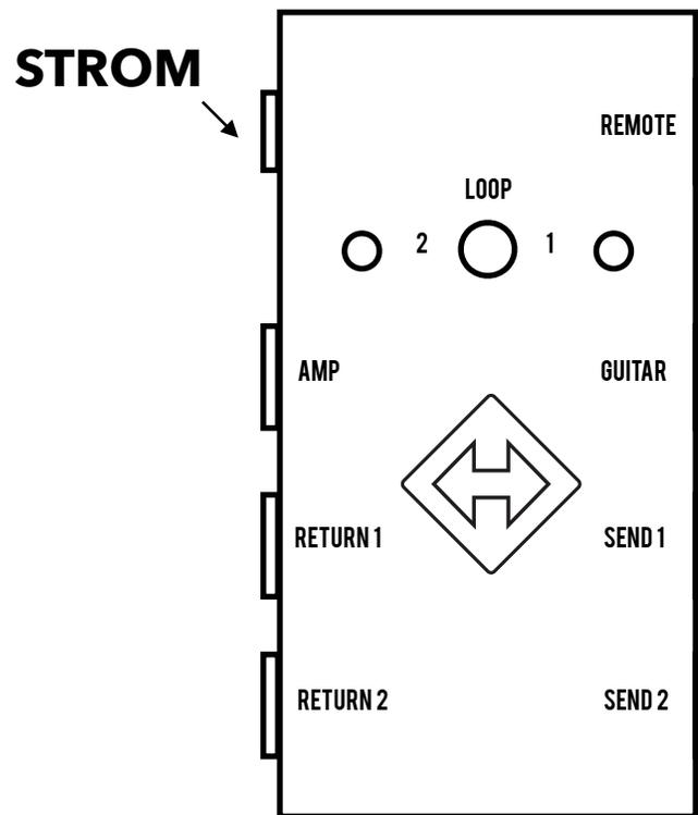
**STROM** - Benötigt 9V DC mit Polarität (-) innen. Nicht mehr als 9V DC verwenden, da sonst etwaige Garantie- oder Gewährleistungsansprüche erlöschen können. 31 mA Stromaufnahme.
