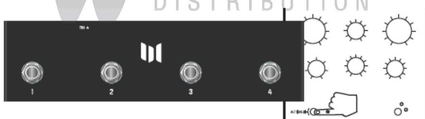
Pro uložení vlastního presetu stiskněte požadovaný nožní přepínač, nastavte požadovaný zvuk a po té na pedálu Meris podržte tlačítko ALT.
