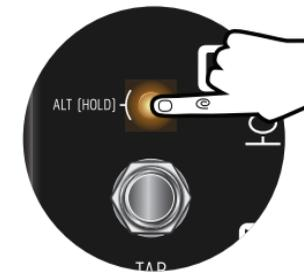
HALTEN Sie den [L] LED-Schalter beim Einstecken der Stromversorgung gedrückt [Start dauert 3 Sekunden]; alle LED blinken 3 Mal. Zum Speichern Stromversorgung ab und wieder anstecken
