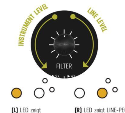
[L] LED zeigt INSTRUMENT-PEGEL an [R] LED zeigt LINE-PEGEL an
