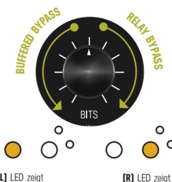
[L] LED zeigt GEPUFFERTEN BYPASS an [R] LED zeigt RELAISBYPASS an
