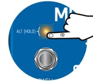
**HALTEN** Sie den **(L)** LED-Schalter beim Einstecken der Stromversorgung gedrückt (Start dauert 3 Sekunden); alle LED blinken 3 Mal. Zum Speichern Stromversorgung ab- und wieder anstecken
