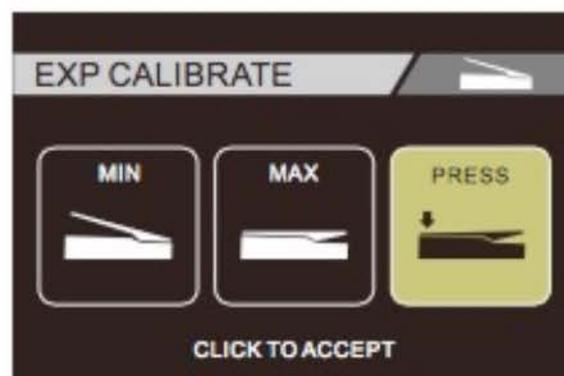
3. Bringen Sie das Pedal in die Ballenposition und drücken Sie das Pedal nach vorne. Drücken Sie währenddessen den VALUE-Regler zur Bestätigung. Dadurch wird die Empfindlichkeit des EXP-Pedal-Schalters festgelegt.
