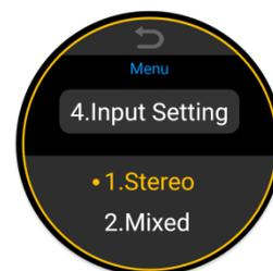
**Stereo:** Verwenden Sie diese Einstellung, wenn an den Eingängen Stereosignale angeschlossen werden (Signale, bei denen eine Unterscheidung zwischen rechtem und linkem Kanal erforderlich ist). Beispiel sind Stereo-Audiogeräte, einige Keyboard, Stereo-Effektgeräte oder zwei separate Instrumente.
