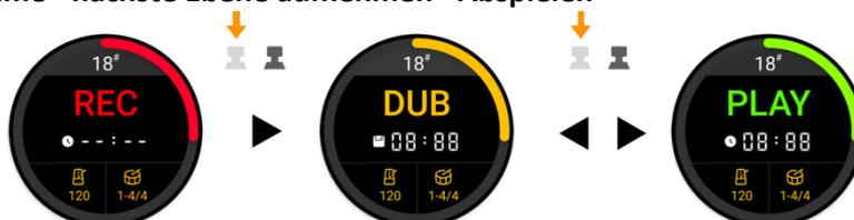
In diesem Modus können Sie die Aufnahme der zweiten Ebene direkt nach Abschluss der Aufnahme der ersten Ebene starten, indem Sie einmal den linken Fußschalter treten. Die erste Ebene wird automatisch abgespielt, während Sie die zweite Ebene darüber aufnehmen.
