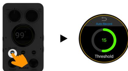
**Methode 1:** Drücken Sie lange auf die AUTO REC Taste, um das Menü zur Schwellwertanpassung zu öffnen und passen Sie den Schwellwert dann durch Drehung des MENU Knopfes an. Klicken Sie auf das "zurück" Symbol am oberen Rand der Anzeige, um zur vorherigen Ansicht zurückzukehren.
