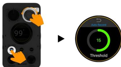
**Methode 2:** Halten Sie AUTO REC gedrückt und drehen Sie gleichzeitig den MENU Knopf, für eine schnelle Anpassung des Schwellwerts. Die Anzeige kehrt automatisch zur vorherigen Ansicht zurück.
