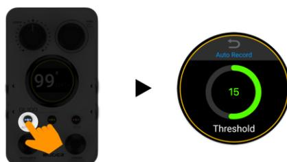
**Methode 1:** Drücken Sie lange auf die AUTO REC Taste, um das Menü zur Schwellwertanpassung zu öffnen und passen Sie den Schwellwert dann durch Drehung des MENU Knopfes an. Klicken Sie auf das "zurück" Symbol am oberen Rand der Anzeige, um zur vorherigen Ansicht zurückzukehren.
