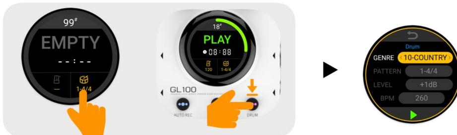
Tippen Sie auf das **Drum Symbol** in der Anzeige oder drücken Sie lange auf die DRUM Taste, um das Menü für den Drum-Computer zu öffnen.
