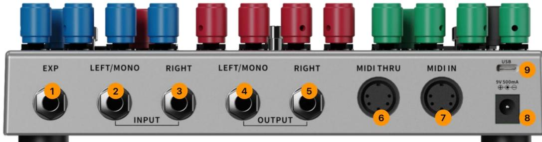
1. **EXP:** 6,35 mm (1/4") TRS-Klinkenbuchse für den Anschluss eines externen Expression Pedals (bitte verwenden Sie ein TRS-Kabel)
