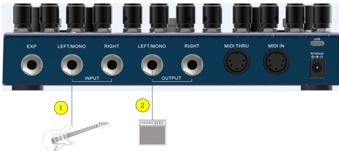
1. Die Gitarre wird an die linke Eingangsbuchse (LEFT/MONO) angeschlossen.
