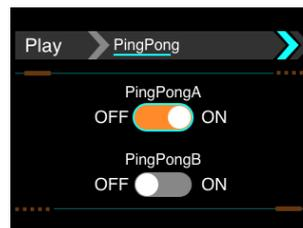
Drücken Sie im **Patch Modus** zunächst gleichzeitig auf die **REV** und **A** Fußschalter, um das Patch Detail Fenster zu öffnen, führen Sie dann die vorgenannten Schritte aus, um den PingPong Effekt einzustellen.
