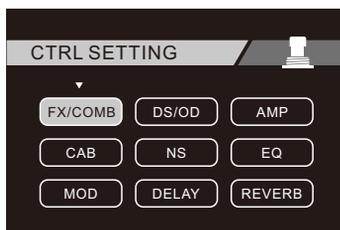
Utilisez le contrôle VALUE pour mettre en évidence et sélectionner les blocs d'effets que vous souhaitez assigner afin qu'ils soient commutables à l'aide du footswitch CTRL/TAP.
