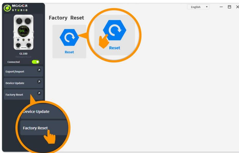
Ce processus a le même effet que l'utilisation de l'option « RESET » du menu du GL100. Après la réinitialisation, toutes les données utilisateur de l'appareil sont effacées et restaurées à leur état d'usine, y compris les fichiers audio enregistrés et importés, les réglages de la boîte à rythmes et les éléments de configuration du menu.
