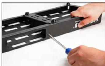
Die Drawer Montageschrauben sind selbstschneidend, sie werden ihr eigenes Gewinde in die vorgebohrten Löcher auf der Vorderseite des **RockBoard®** Pedalboards schneiden. Verwenden Sie einen TX10 Schraubendreher, um die Montageschrauben einzudrehen und dabei die Gewinde zu schneiden. Sollten Sie keinen TX10
