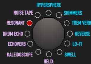
Im Kern ist RESONANT ein analoges Delay. Das einzigartige, federnde, zirpende Gefühl eines analogen Delays war ursprünglich das Nebenprodukt der Verwendung eines Tiefpassfilters, je nach Schaltungsdesign mehr oder weniger resonant, um Aliasing herauszufiltern, ein unerwünschtes, hochfrequentes Bit-Crush Rauschen, das von der Bucket Brigade (BBD)-Schaltung erzeugt wird.
