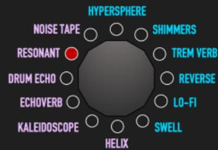
À la base, RESONANT est un delay analogique. La sensation unique, élastique et vibrante d'un delay analogique était à l'origine le résultat secondaire de l'utilisation d'un filtre passe-bas, plus ou moins résonnant selon la conception du circuit, pour filtrer l'aliasing, un bruit indésirable de bit crush à haute fréquence généré par le circuit Bucket Brigade (BBD).
