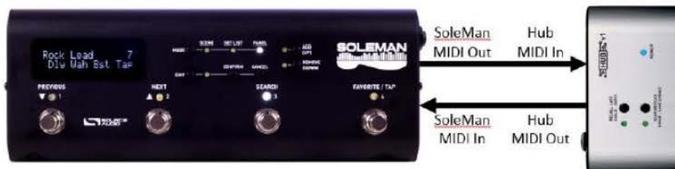
Po té, co propojíte obě jednotky pomocí MIDI kabelů, v obrazovce menu Edit Menu si „nalistujte“ nabídku „Use Hub Names“. Použitím nožních přepínačů Previous/Next poté nastavte hodnotu „Yes“ (ano).
