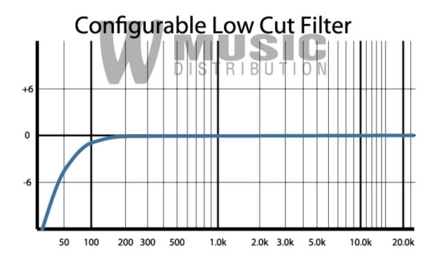
Der Parametric-EQ und der Low-Cut-Filter können über den Neuro-Hub konfiguriert werden. In der Standardeinstellung ist der Parametric-EQ deaktiviert (flat) und der Low-Cut-Filter steht bei 10 Hz.
