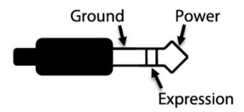
Für die meisten Expression-Pedale wird ein 6,35mm-Klinkenstecker verwendet, wohingegen beim Control-Input des Kingmaker ein 3,5mm-Stecker zum Einsatz kommt. Um trotzdem eine Verbindung herzustellen, kann ein einfacher TRS-Stecker-Converter (6,35mm auf 3,5mm) verwendet werden.
