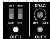
Das Headlight schaltet nur zwischen den Ausgängen hin und her, an die ein Verstärker angeschlossen ist. Wenn nur OUTPUT-1 verwendet wird, hat der SELECT-Schalter keine Wirkung.
