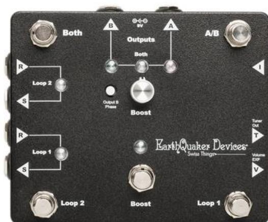
*Die Oberseite des Swiss Things ist mit fünf Fußschaltern, mehreren LEDs und einem Poti bestückt.*
