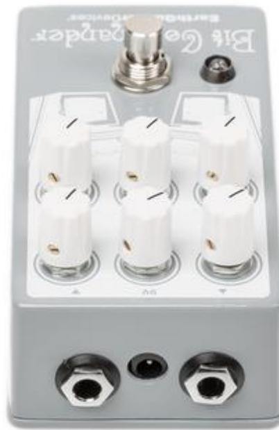
*Ein- und Ausgangsbuchse sind auf der Stirnseite des Pedals angebracht.*
