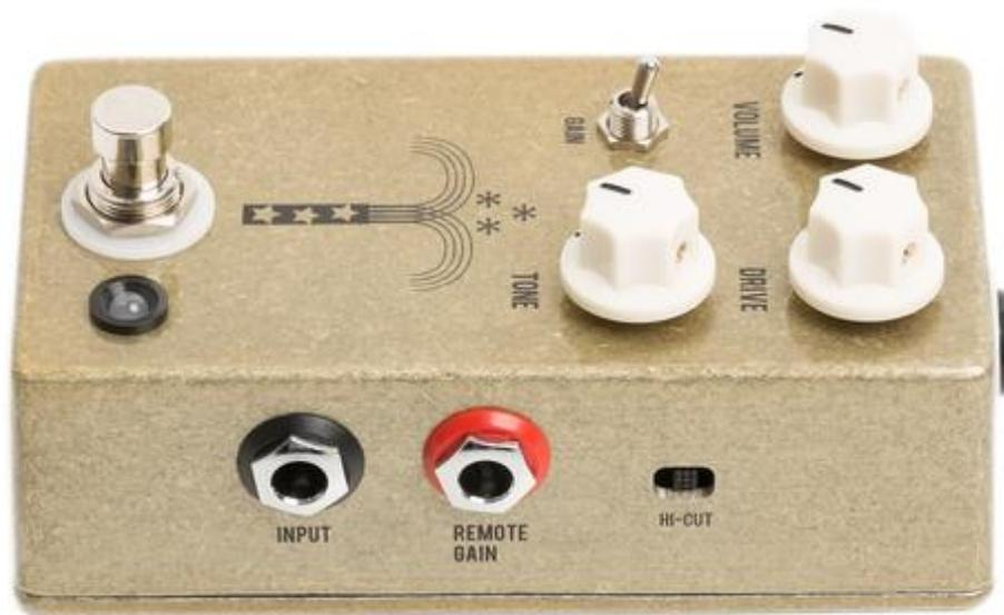
Die rechte Gehäuseseite beherbergt die Eingangsbuchse und den zusätzlichen Fußschalteranschluss für die Gain-Stufen.
