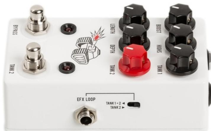
Auf der rechten Seite befindet sich eine Stereobuchse für den Einschleifweg per Y-Kabel...
