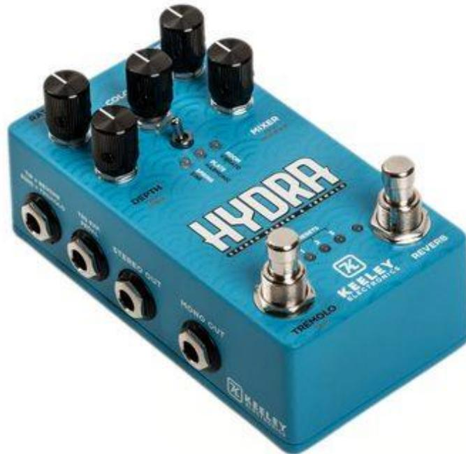
*Stereo-Reverb und Tremolo-Effekte vereinen sich im neuen Keeley Hydra Effektpedal das 120 x 68 x 58 mm (L x B x H) groß ist und dessen Verarbeitung einen soliden Eindruck hinterlässt. Drei Speicherplätze und das Signal-Routing der beiden Effekte gehören zu den interessanten Features des Pedals.*
