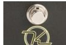
Auf der Stirnseite sitzt schließlich noch eine dritte Buchse zum Anschluss eines 9V-Netzteils (Minuspol innen). Für ein passendes Netzteil muss man jedoch leider abermals das Portemonnaie zücken, denn es gehört nicht zum Lieferumfang. Alternativ kann man den Bassist Compressor einfach mit einer handelsüblichen 9V-Batterie, die nach Entfernung der mit vier Schrauben befestigten Bodenplatte in das Pedal eingelegt werden kann.
