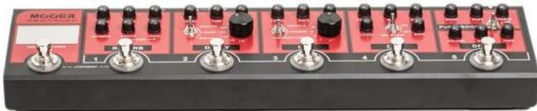
Mit dem Mooer Red Truck hat der chinesische Hersteller von Effektpedalen im XXS-Format ein Multi-Effektpedal im Programm, das in seinem Gehäuse Hall, Echo, Modulationseffekte, Distortion, Overdrive und Booster bereithält. Das Besondere an dieser Konstruktion sind die Regler, die jedes Pedal für diverse Parameter bereithält und die ein intuitives Bedienen ermöglichen, ohne in irgendwelche Programmiererebenen eintauchen zu müssen.
