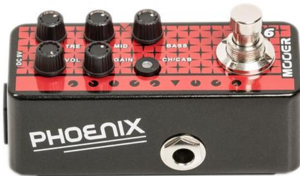
*Die Klinkenbuchsen für das Eingangs- und Ausgangssignal...*
