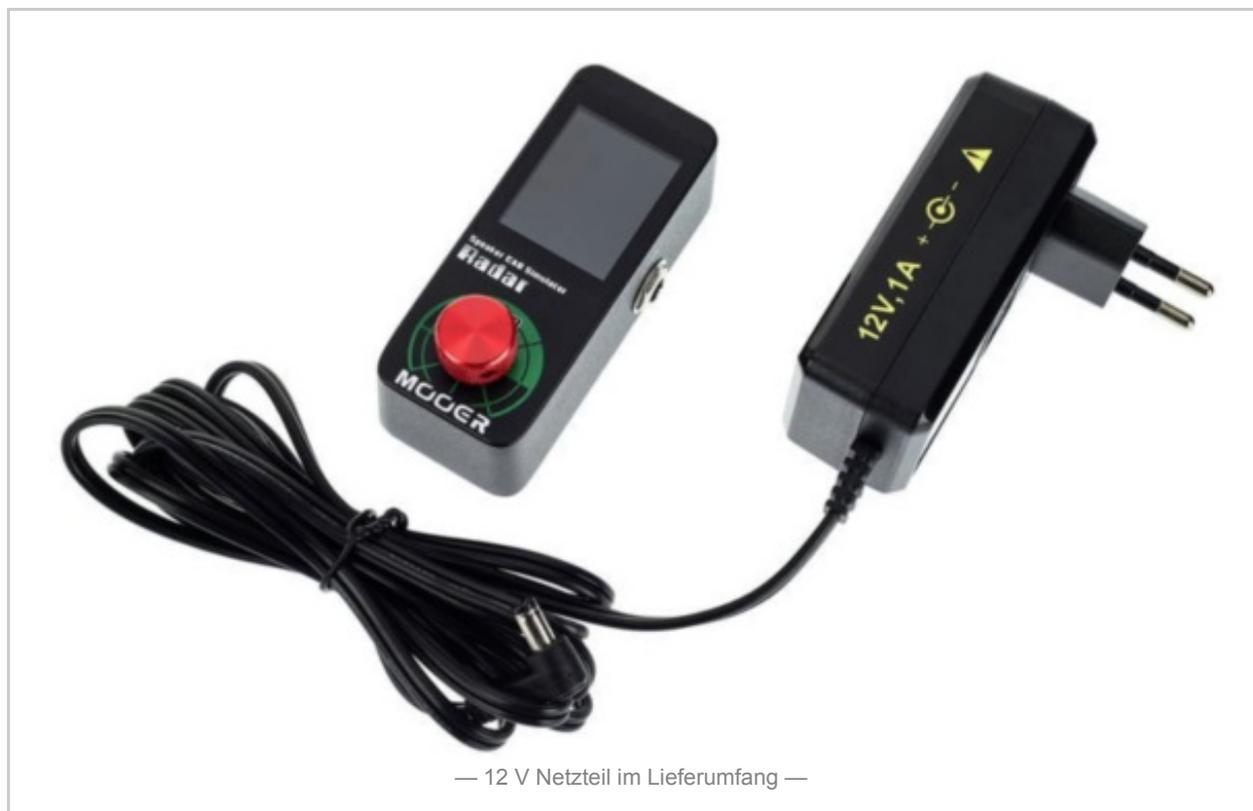
Die Stromversorgung erfolgt über das mitgelieferte 12-Volt-Netzteil. Der Stromverbrauch fällt mit seinen satten 300 mA recht hoch aus. Das kann man auch feststellen, wenn man das **Moorer Radar** nach einigen Minuten Betrieb berührt, es wird nämlich warm. Heiß bzw. mehr als handwarm wird es glücklicherweise nicht.
