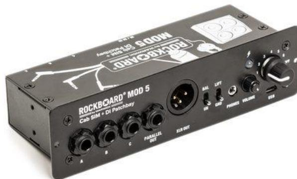
*Das Rockboard MOD 5 bietet flexible Routingmöglichkeiten und die Möglichkeit eigene Impulsantworten für die Speakersimulation zu verwenden .*
