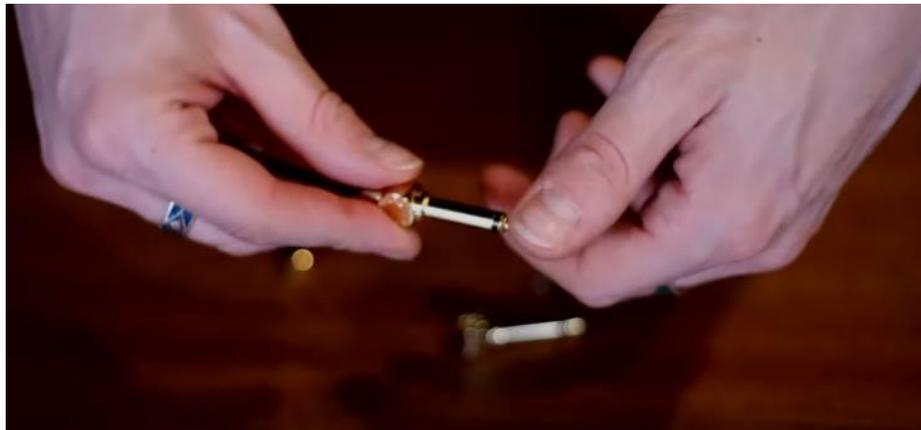
Dann kommt der TX8 Schlüssel ins Spiel, mit der die Schraube entsprechend befestigt wird. Die zwei Teile des Steckers also – die Kabelführung und der Schaft, werden mit der Schraube zusammengeführt und miteinander befestigt, nachdem man den Innenleiter des Kabels auf den Kontakt des oberen Steckers befestigt hat.
