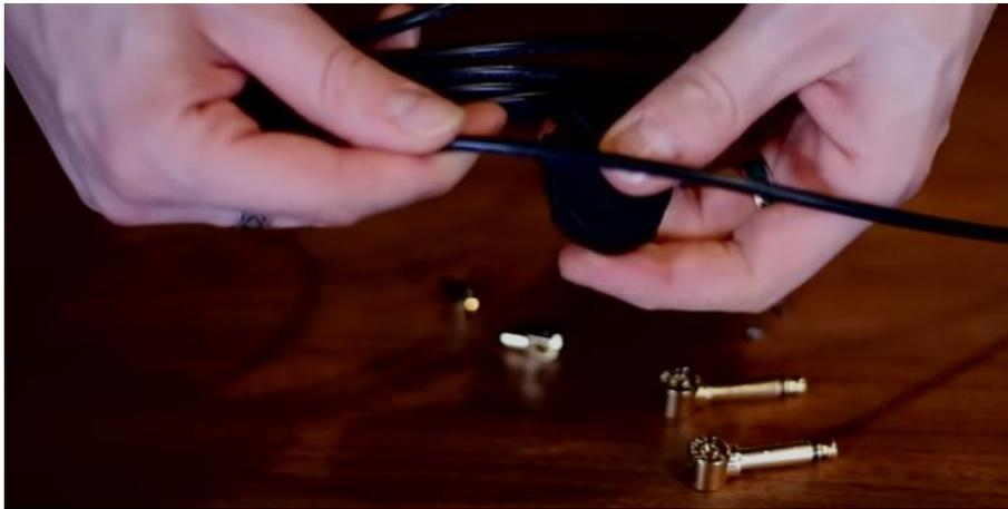
Jetzt steht man entweder vor seinem Modularsystem oder seinem Pedalboard, hat die Maße, die benötigt werden, ausgemessen. Im nächsten Schritt einfach das runde, recht sicher konstruierte Kabelmesser zur Hand nehmen und zack – saubere Kabelenden sind gemacht.
