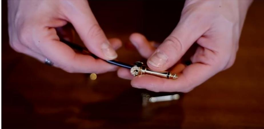
Bei einem Winkelstecker muss entsprechend darauf geachtet werden, die Kabelführung zu drehen, bis sie befestigt ist und dann knicken – funktioniert ebenfalls problemlos. Der hintere Teil des zweiteiligen Stecker wird auf den vorderen geschoben.
