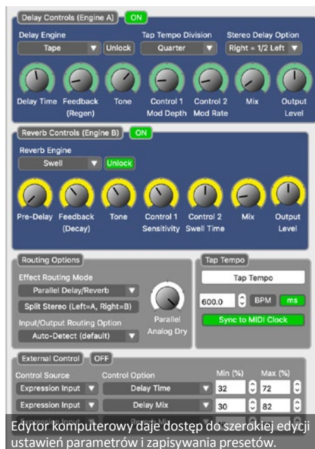
Z poziomu panelu mamy dostęp do zapisanych 8 presetów (4 kolejne po naciśnięciu przycisku na tylnej ścianie).
