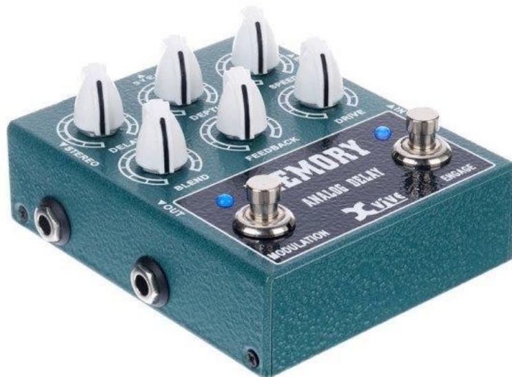
Zwei robuste Metallschalter dienen zum Aktivieren des Effekts und zum Zuschalten der Modulationseinheit, dessen Intensität auf Wunsch mit einem Expression Pedal in Echtzeit gesteuert werden kann. So meint es zumindest der Hersteller. Zwei nicht zu helle, blaue LEDs informieren über den momentan ausgewählten Modus.
