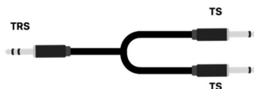
(kabelová redukce z jednoho TRS na dva TS konektory)
