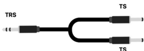
(Pojedynczy port stereo FX LOOP) (Prześciówka z TRS na podwójny TS, kabel Y)
