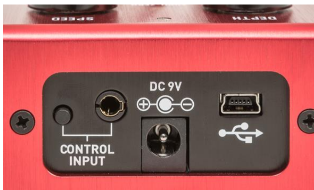
...Control-Input, Netzteilanschluss und USB
