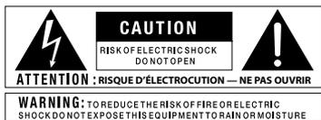
Les symboles ci-dessus avertissent l'utilisateur des dangers potentiels résultant de la mauvaise utilisation des appareils électriques. Le symbole de l'éclair dans un triangle équilatéral avertit l'utilisateur de la présence d'une tension électrique pouvant constituer un risque d'électrocution. Le symbole du point d'exclamation dans un triangle équilatéral indique que l'utilisateur doit se reporter au mode d'emploi pour obtenir des consignes d'utilisation.
