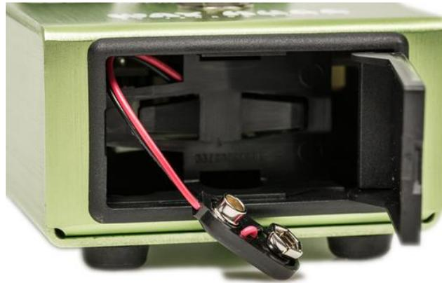
*Dank Schnappverschluss ist der Batteriewechsel in Sekunden erledigt.*
