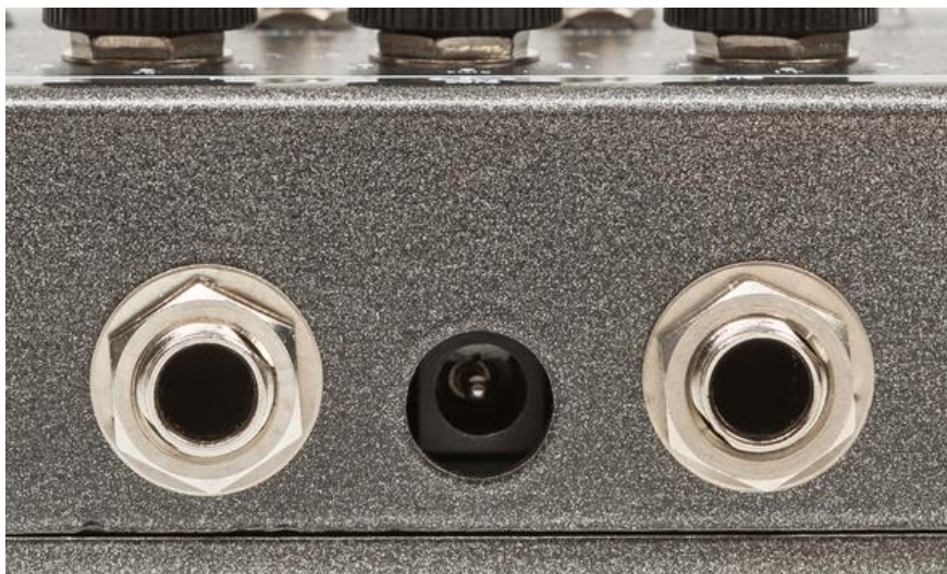
Das Pedal arbeitet ausschließlich mit 9V DC-Netzteil - für eine Batterie ist schlicht kein Platz mehr im prall gefüllten Gehäuse
