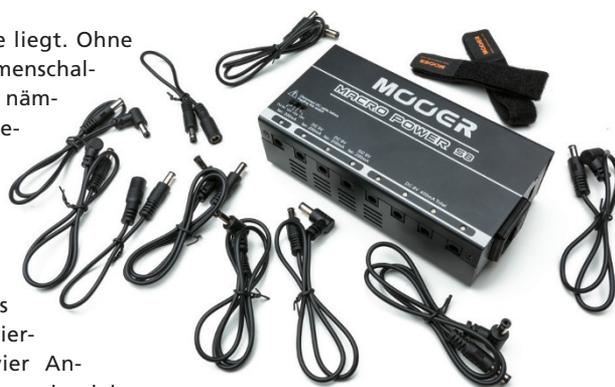
lung. Alle Ausgangsspannungen sind sorgfältig gesiebt und elektronisch stabilisiert, damit sich kein Brumm in die Wiedergabe einschleichen kann und auch bei wechselnder Belastung die korrekten Spannungen bereitstehen. Damit wird das Macro-Power-Modul die allermeisten Speisungsaufgaben in hoher Güte lösen.
