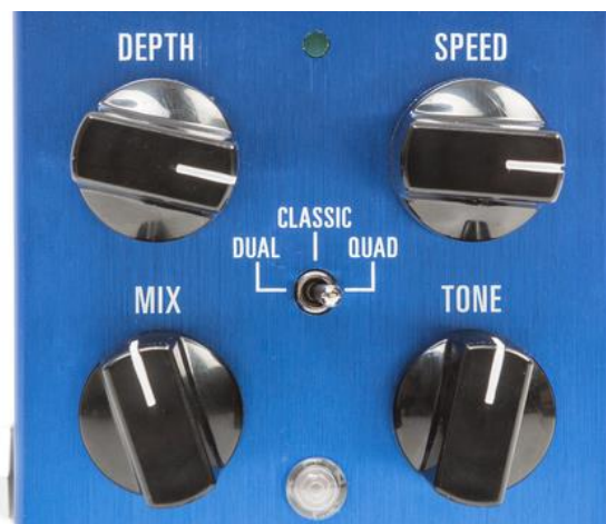
Es stehen drei Soundmodi zur Verfügung, die sich über einen Kippschalter anwählen lassen
